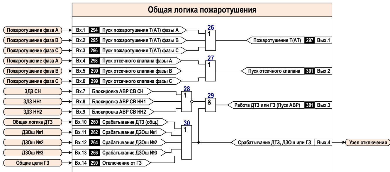
Рисунок 40 – Функциональная логическая схема общей логики пожаротушения
